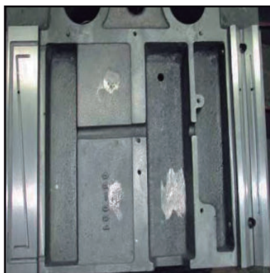
Sistema interno de lubricación en la base.
