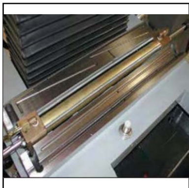
Deslizamiento longitudinal hidráulico sobre plano y prisma.
