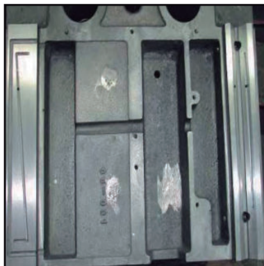
Sistema interno de lubricación en la base.
