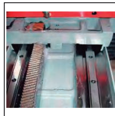
Piñón y cremallera de arrastre longitudinal.
