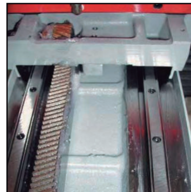
Piñón y cremallera de arrastre longitudinal.
