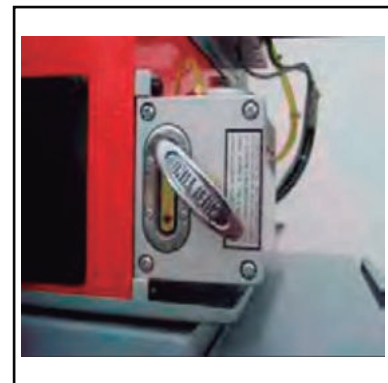
Bomba de engrase centralizado.
