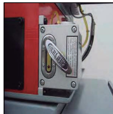
Bomba de engrase centralizado.
