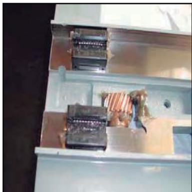
Deslizamiento longitudinal sobre guía de patines NSK
