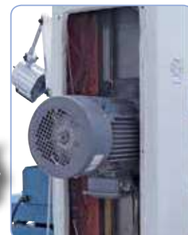
La resistente guía del cabezal de rectificado garantiza un ajuste exacto.
