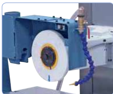
Funcionamiento con mínimas vibraciones y elevada precisión del husillo de rectificar mediante rodamientos pretensados.
