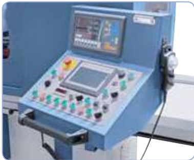
Incluye panel Siemens SAMRT IE V3 con pantalla táctil y volante electrónico
