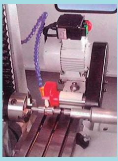
Rectificado cilíndrico exterior con muelas de hasta 100 mm de diámetro, 6.000rpm
