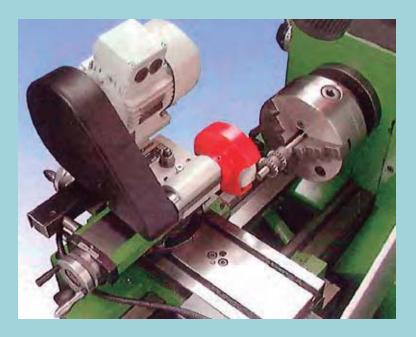
La rectificadora de carro se ha diseñado de tal forma que se puede utilizar en todos los tornos para el rectificado interior, el rectificado exterior y el refrentado (versión estándar, a la derecha)
