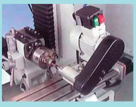
Rectificado cilíndrico interior con fresas abrasiva y 24.000rpm.
