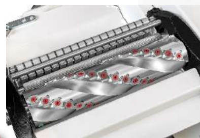
Cabezal helicoidal 3 filas de 17 plaquitas
